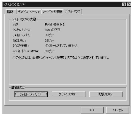
「32ビット」と表示されていれば、PCカードを使用できる状態にあります。「CardBus対応の確認」に進んでください。「32ビット」と表示されていないときは、手順4に進んでください。
