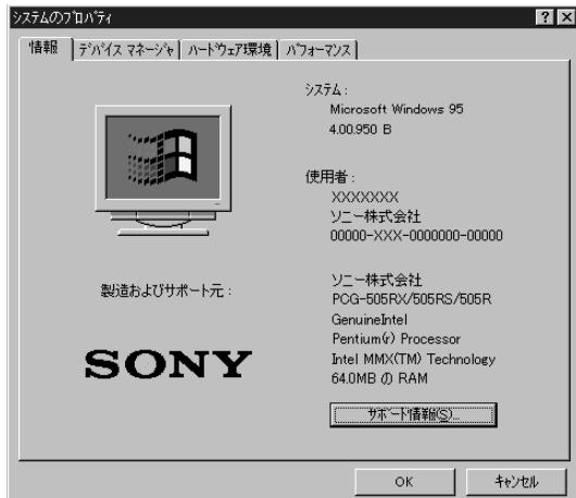
バージョンが4.00.950Bまたは4.00.950Cであれば次の「PCカードスロットの仕様を確認する」に進んでください。それ以前のバージョンであれば、ご使用のパソコンは16 bitモードだけに対応しています。「PCカードのモードスイッチ設定」に進んでください。
